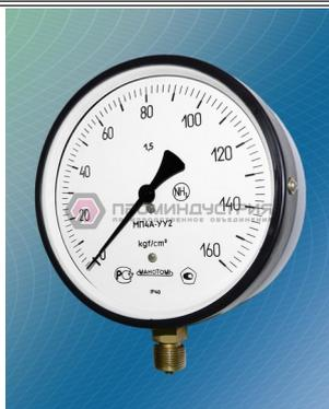
**Вакууметр ВП4А-У** предназначен для измерения вакууметрического давления жидкого, газообразного и водного раствора аммиака. Приборы могут иметь дополнительную температурную шкалу. Корпус: сталь, алюминиевый сплав. IP40 (по заказу - IP53). Стекло: оконное.
