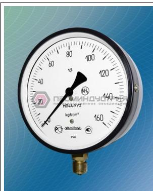
**Манометр МП4А-У предназначен для измерения избыточного давления жидкого, газообразного и водного раствора аммиака. Приборы могут иметь дополнительную температурную шкалу. Корпус: сталь, алюминиевый сплав. IP40 (по заказу - IP53). Стекло: оконное.**
