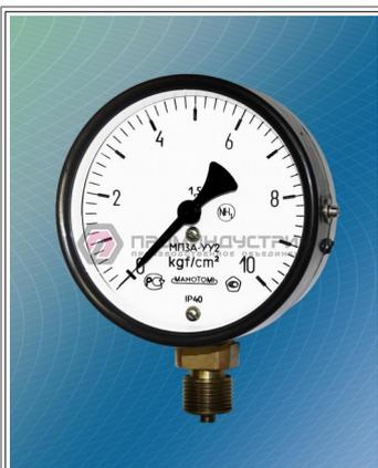
Мановакууметр показывающий MBPZA-U предназначен для измерения избыточного и вакууметрического давления жидкого, газообразного и водного раствора аммиака. Приборы могут иметь дополнительную температурную шкалу. Корпус: сталь, алюминиевый сплав. IP40 (по заказу - IP53). Стекло: оконное. Механизм: нержавеющая сталь\*, алюминиевый сплав. Штуцер: сталь. Температура измеряемой среды: -50 до +60°C.
