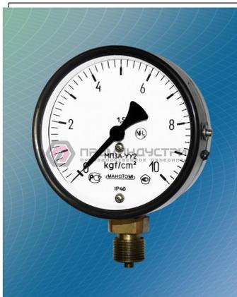
Вакууметр показывающий ВПЗА-У предназначен для измерения вакууметрического давления жидкого, газообразного и водного раствора аммиака. Приборы могут иметь дополнительную температурную шкалу. Корпус: сталь, алюминиевый сплав. IP40 (по заказу - IP53). Стекло: оконное. Механизм: нержавеющая сталь\*, алюминиевый сплав. Штуцер: сталь. Температура измеряемой среды: -50 до +60°C.
