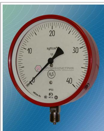
Манометры показывающие ВП4А-Кс предназначены для измерения вакуумметрического давления углеводородного газа и водогазонефтяной эмульсии с содержанием сероводорода (H<sub>2</sub>S) и углекислого газа (CO<sub>2</sub>) до 25 % объемных каждого, неорганических солей и парафина до 10 % весовых. Корпус: алюминиевый сплав. IP53. Стекло: оконное.
