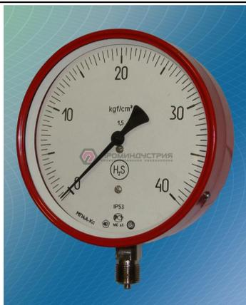
**Манометры показывающие МП4А-Кс предназначены для измерения избыточного давления углеводородного газа и водогазонефтяной эмульсии с содержанием сероводорода (H<sub>2</sub>S) и углекислого газа (CO<sub>2</sub>) до 25 % объемных каждого, неорганических солей и парафина до 10 % весовых. Корпус: алюминиевый сплав. IP53.**
