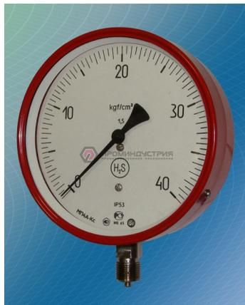
**Манометр коррозионностойкий ТМ-521 выполнен полностью из нержавеющей стали. Применяется для измерения давления агрессивных жидких и газообразных, не вязких и не кристаллизующихся измеряемых сред с температурой до 200 °С. Штуцер: Нержавеющая сталь.**
