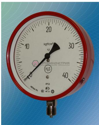
**Манометр коррозионностойкий ТМ-621 выполнен полностью из нержавеющей стали. Применяется для измерения давления агрессивных жидких и газообразных, не вязких и не кристаллизующихся измеряемых сред с температурой до 200 °С. Штуцер: Нержавеющая сталь.**
