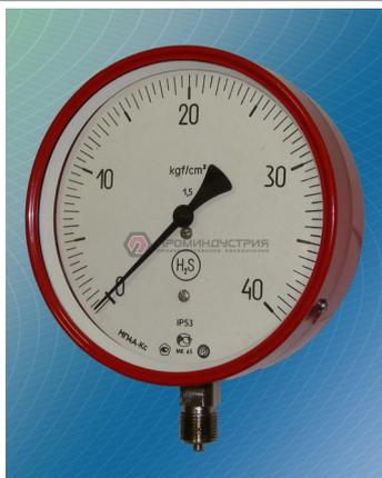
**Манометры показывающие МВП4А-Кс предназначены для измерения избыточного и вакуумметрического давления углеводородного газа и водогазонефтяной эмульсии с содержанием сероводорода (H<sub>2</sub>S) и углекислого газа (CO<sub>2</sub>) до 25 % объемных каждого, неорганических солей и парафина до 10 % весовых. Корпус: алюминиевый сплав. IP53. Стекло: оконное. Механизм: нержавеющая сталь, алюминиевый сплав. Штуцер: нержавеющая сталь. Температура измеряемой среды: -50 до +50°С.**
