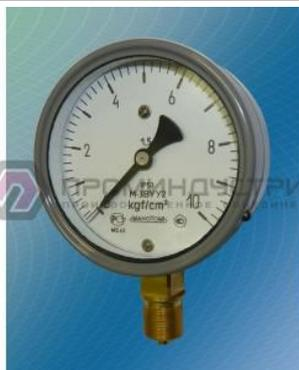
**Мановакууметр показывающий виброустойчивый MB-ЗВУ предназначен для измерения избыточного и вакууметрического давления некристаллизующихся жидкостей, паров, газов, в том числе кислорода, ацетилена, сероводородсодержащих сред, хладонов 12, 13, 22, 142, 502, 134а и 404а, газодонефтяной эмульсии, нефти и нефтепродуктов в промышленных установках, в судовых системах и гидравлических бурильных и насосных установках. Корпус: алюминиевый сплав. IP53.**
