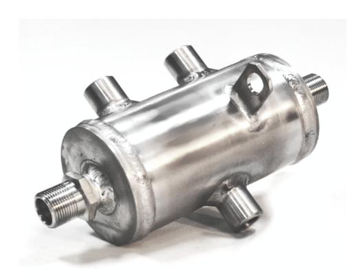
Разделительные сосуды предназначены для защиты чувствительных элементов контрольно-измерительных приборов от агресивного воздействия измерямой среды.Разделительные сосуды служат резервуаром для разделительной жидкости, благодаря которой, чувствительный элемент датчика избегает контакта с измеряемой средой. При этом передача давления через разделительную жидкость осуществляется без потерь в точности измерений.
